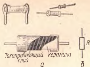
Рис. 23. Резисторы (а) и их символическое обозначение на схемах (б)
