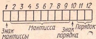
Рис. 47. Структура индикатора ПМК
